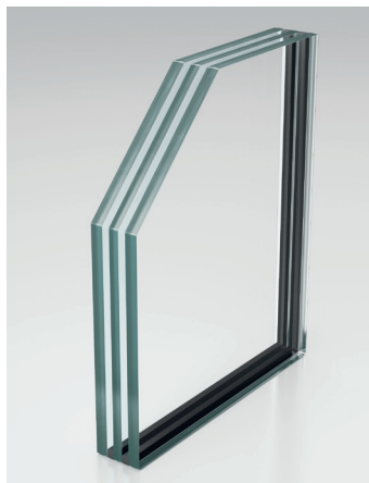
Gelaagd glas met silicaatlayers: wanneer bij een brand het glas breekt, schuimt die tussenlaag op en vermindert de warmtestraling en de temperatuur. Ook vormt het een tijdelijke barrière tegen rook en vlammen.
